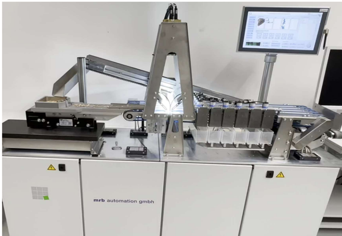
Abbildung 2: Angepasster Demonstrator zur Sortierung von Ziegelpartikeln im Größenbereich von 2-8 mm
