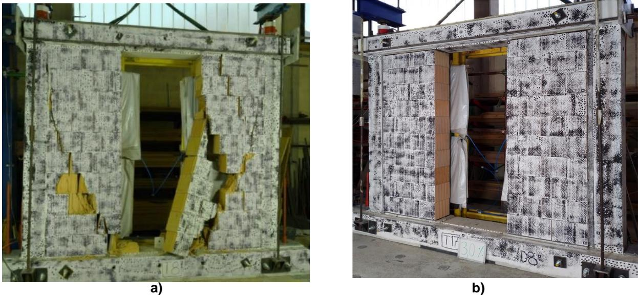
Abbildung 5: a) Traditionelles System bei 1,6 % Drift und b) entkoppeltes System bei 3,0 % Drift
