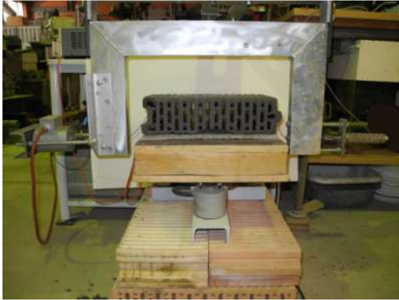
Bild 1: Für Vibrationsversuche konstruierter Tonschneider mit piezoelektrischem Aktor links und Kraftmessdose (horizontal) rechts
